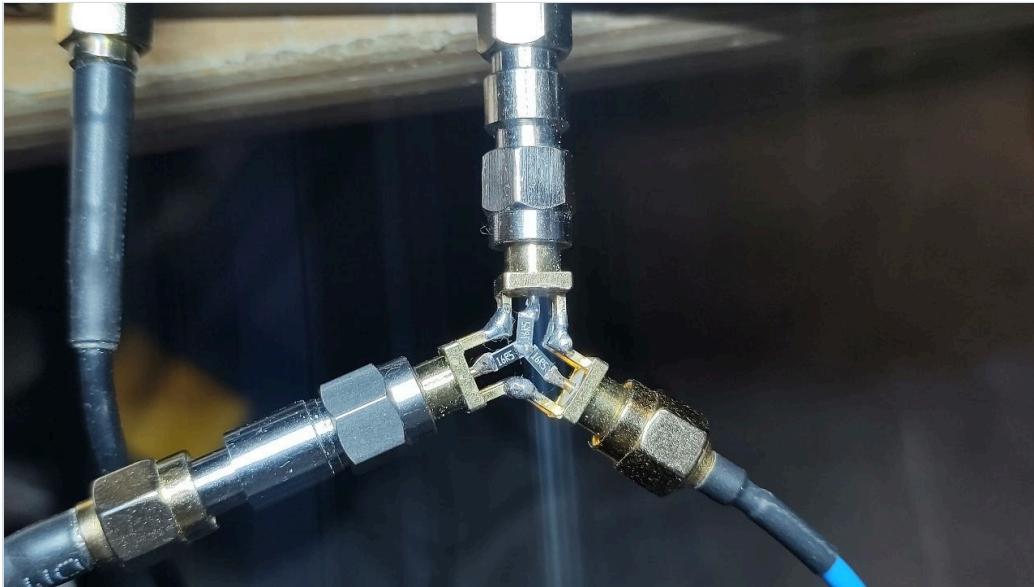
Zelfgemaakte splitter: drie SMA-bussen met drie SMD-weerstanden van 16,5\ \Omega in een ster.
