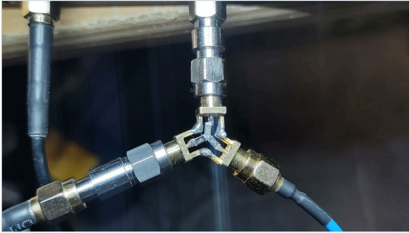
Zelfgemaakte splitter: drie SMA-bussen met drie SMD-weerstanden van 16,5 \Omega in een ster. Elke tak verliest 6 dB.
